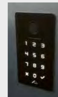
Durch Berührung der Tastatur werden die Zahlen sichtbar.
